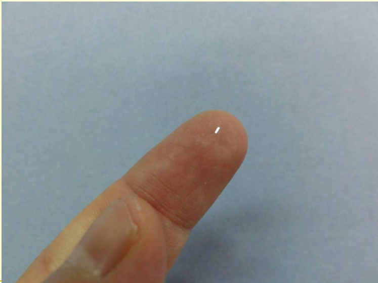
開発したラマンレーザーチップ 数百個載せられる
