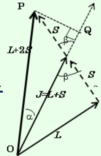
図 2.21 OP( L+2S )の J への投影 OQ が磁気モーメントを与える
