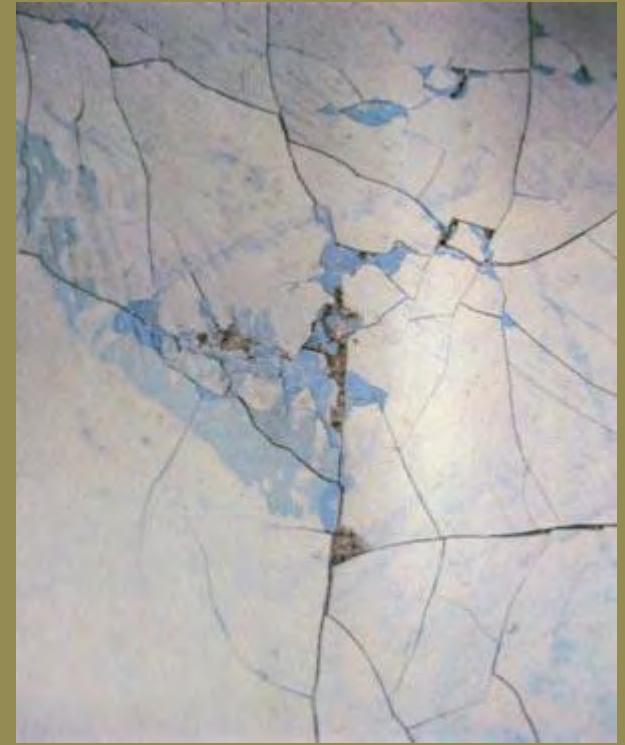
ジンクホワイトで描いた油絵を14年保存後に巻いたときの亀裂と剥離
