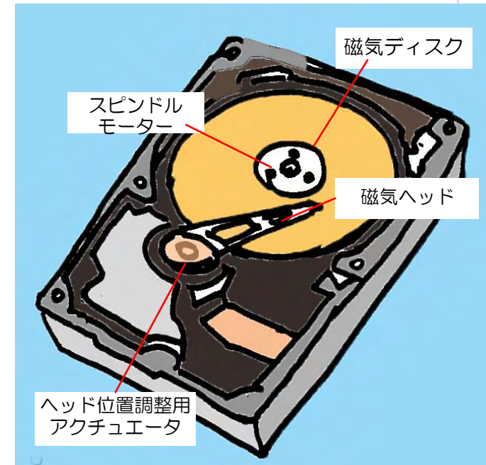
図1.3 パソコンのハードディスクドライブ(HDD)には、記録媒体としてハード磁性体が、記録ヘッドにはソフト磁性体が使われている
