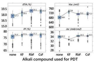
で 85%、開放電圧で 80%でしかない。ここまで効率が向上したのは、アルカリフッ化物での堆積後アニール(PDT) によるところが大きい。 22.6%の効率は RbF を使った PDT によるものである¹。 GGI=Ga/(Ga+In)のグレーディング・プロファイルによっても変換効率が改善される。一方、遷移金属不純物の混入はネガティブな効果を持ち、特に Fe は 0.1ppm 以下でも効率を大きく低下させる。さらに、CdS-free、ZnO:Al の採用で短波長量子効率改善と防湿改善が図られる。 さらに植物の葉っぱの表面構造を模倣すると反射の低減が図られること、背面電極の改善によっても光の高効率利用が図られることなどを総合することで 25%は可能であると述べた。
