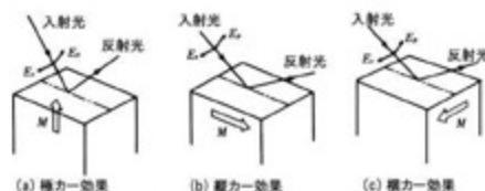
図4 磁気光学効果の3つの配置
