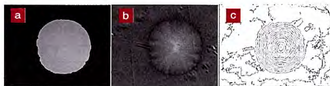
図13 MgB_2 の円形パターンに磁束が侵入するさまの画像。a) 転写膜なし、b) 転写膜あり、c) 電流分布の計算結果 (文献8)
