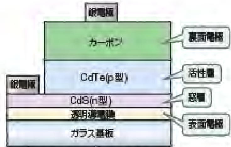
太陽光はガラス基板から入射する
