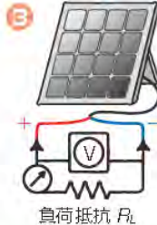
負荷直線は、負荷抵抗 R_L をつないだときに抵抗の両端に現れる電圧と流れる電流の関係
