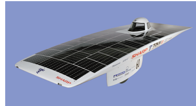
このソーラーカーは化合物半導体系のInGaP/InGaAs/Ge太陽電池を搭載していた
